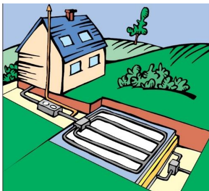
Figure 22 : Exemple de filière d'épuration par un sable de substitution – filtre à sable vertical drainé (source : Agence de l'eau Loire-Bretagne)
