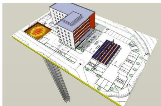
Les puissances de ce type de système peuvent aller de 50 kW à 4 MW selon le diamètre et la profondeur de l'installation. Par exemple, une installation de 32m de rayon (3 200 m<sup>2</sup>) à 30m
